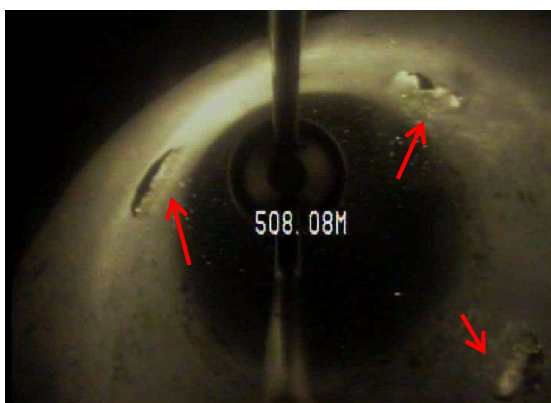
FOTOGRAMA 10 - Visada de fundo aos 508,09 m* mostrando furos no tubo.
