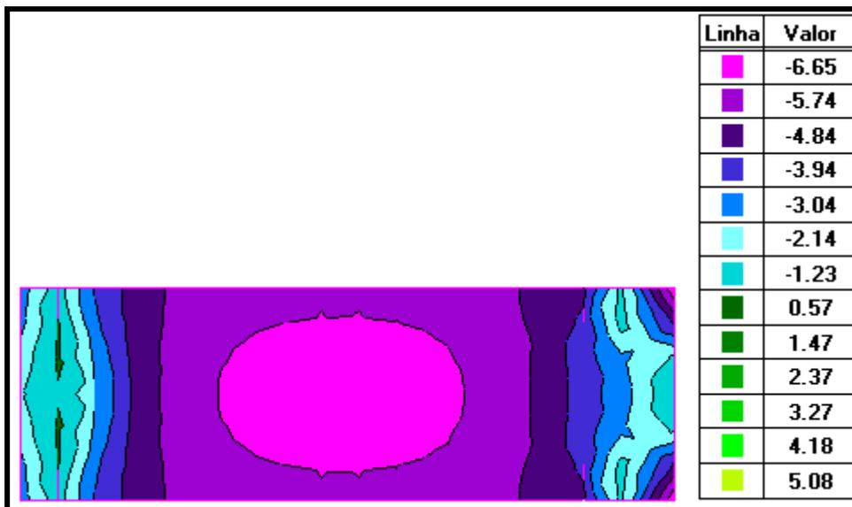
FUNDO 04 – ENVOLTÓRIA DE CARREGAMENTOS MAX - FORÇAS NA DIREÇÃO DE Y (tf/m)
