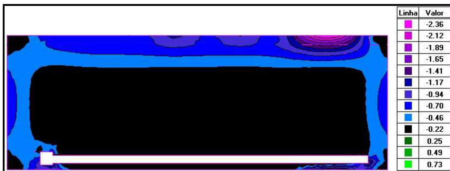
FUNDO – NÍVEL 43.000 – ENVOLTÓRIA DE CARREGAMENTOS MAX - MOMENTO NA DIREÇÃO DE Y (tf.m/m)
