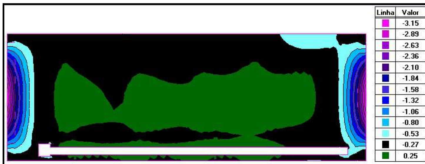
FUNDO – NÍVEL 43.000 – ENVOLTÓRIA DE CARREGAMENTOS MAX - MOMENTO NA DIREÇÃO DE X (tf.m/m)
