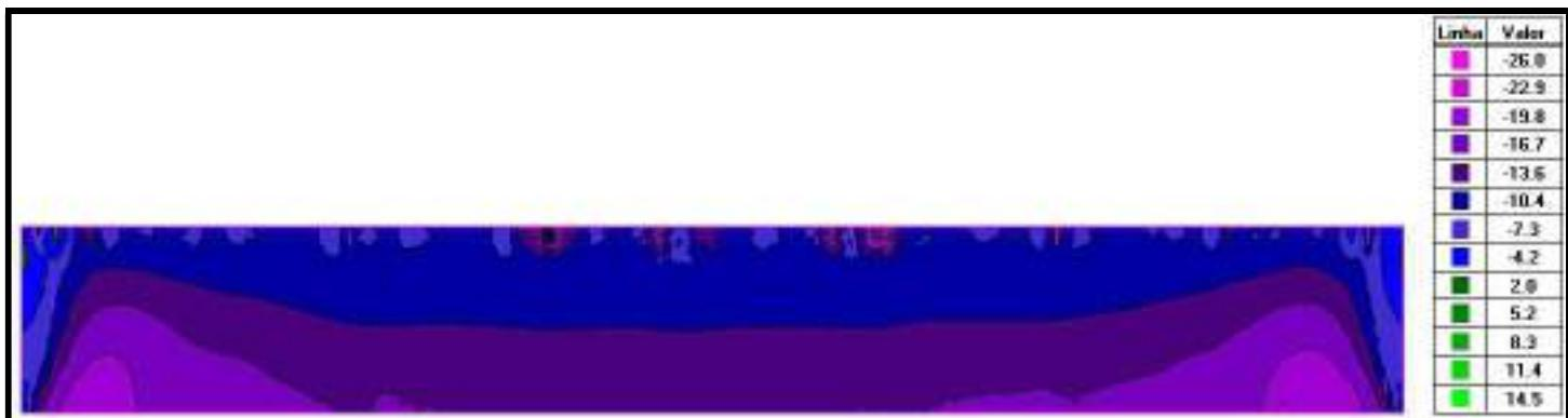
PAR4=PAR5 – ENVOLTÓRIA DE CARREGAMENTOS MIN - FORÇAS NA DIREÇÃO DE Y (tf/m)
