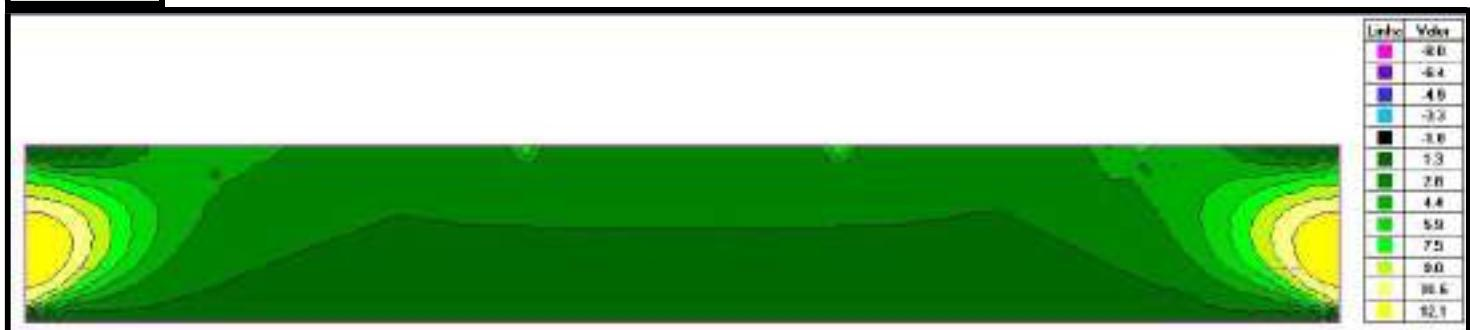
PAR6 – ENVOLTÓRIA DE CARREGAMENTOS MAX - FORÇAS NA DIREÇÃO DE X (tf/m)
