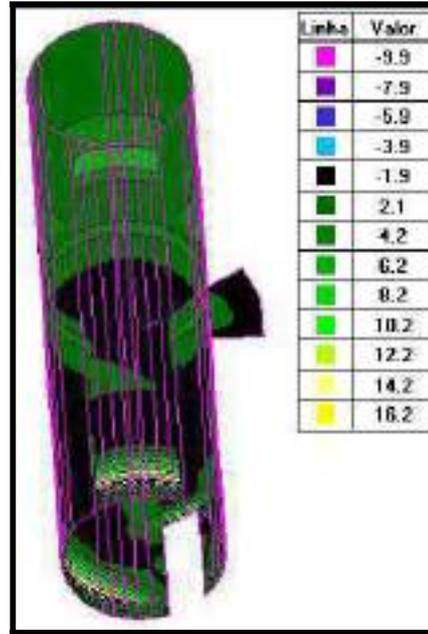
PAREDE - ENVOLTÓRIA DE CARREGAMENTOS MAX - FORÇAS NA DIREÇÃO DE X (tf/m)
