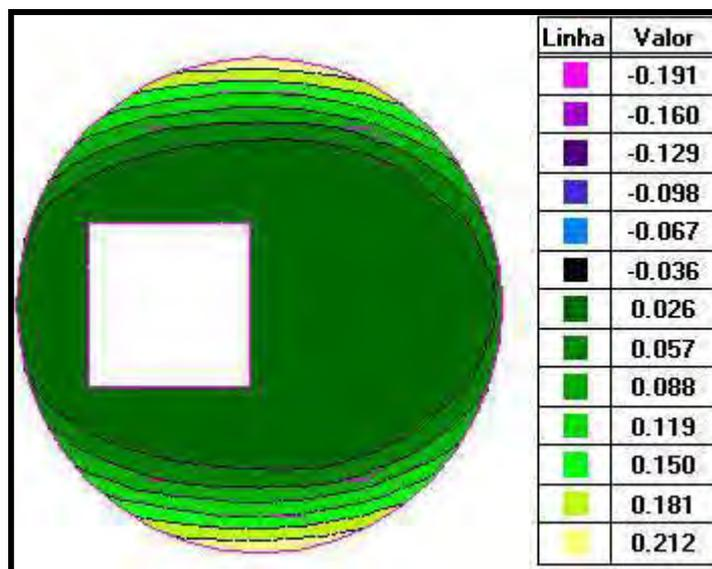
TAMPA – ENVOLTÓRIA DE CARREGAMENTOS MAX - MOMENTO NA DIREÇÃO DE Y (tf.m/m)
