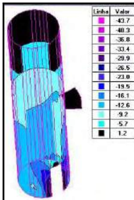
PAREDE – ENVOLTÓRIA DE CARREGAMENTOS MIN – FORÇAS NA DIREÇÃO DE Y (tf/m)
