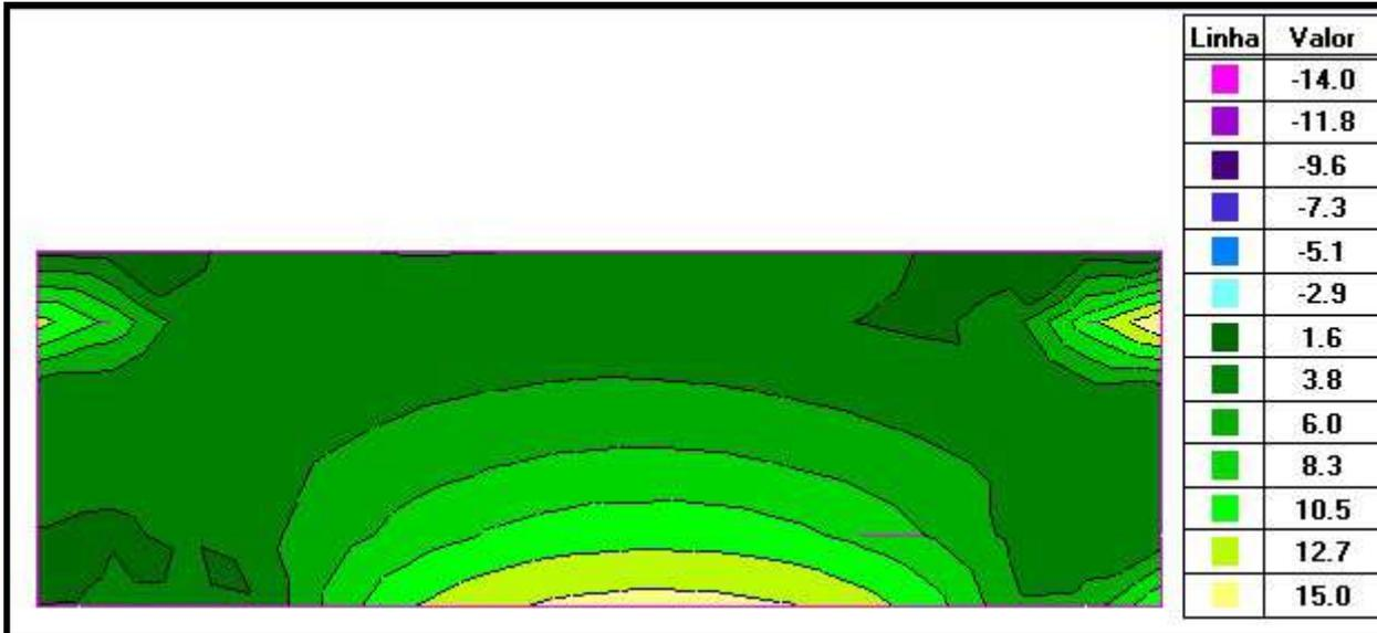
PAR3 – ENVOLTÓRIA DE CARREGAMENTOS MAX - FORÇAS NA DIREÇÃO DE X (tf/m)
