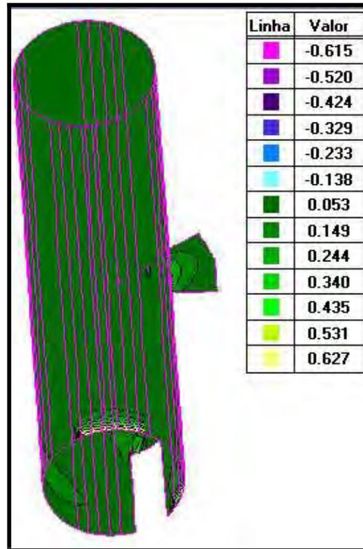
PAREDE - ENVOLTÓRIA DE CARREGAMENTOS MAX - MOMENTO NA DIREÇÃO DE X (tf.m/m)
