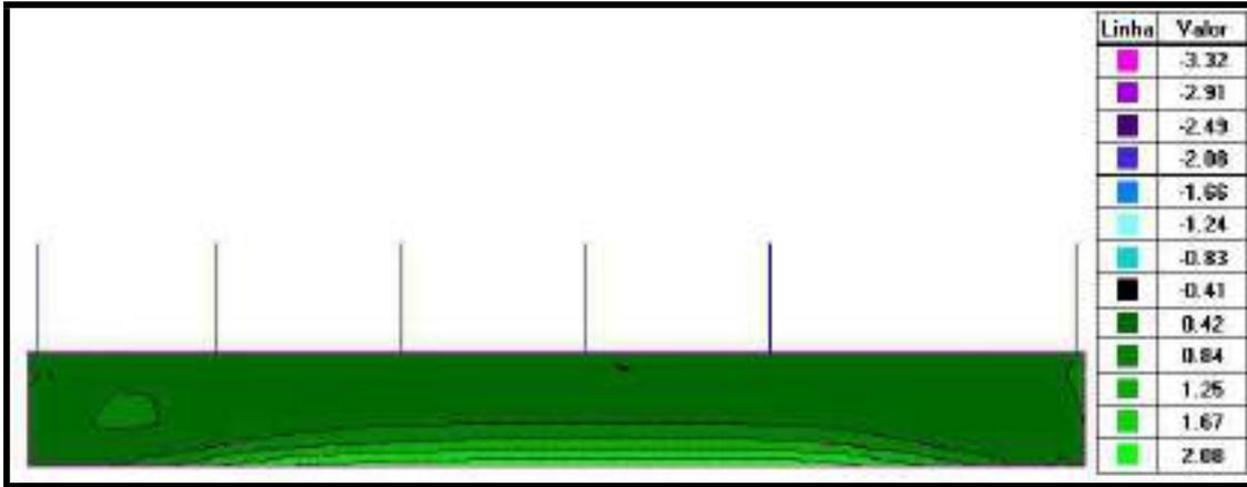
PAR2 – ENVOLTÓRIA DE CARREGAMENTOS MIN - MOMENTO NA DIREÇÃO DE Y (tf.m/m)
