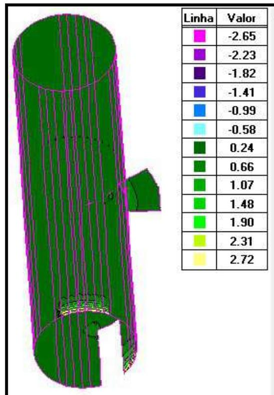
PAREDE - ENVOLTÓRIA DE CARREGAMENTOS MAX - MOMENTO NA DIREÇÃO DE Y (tf.m/m)
