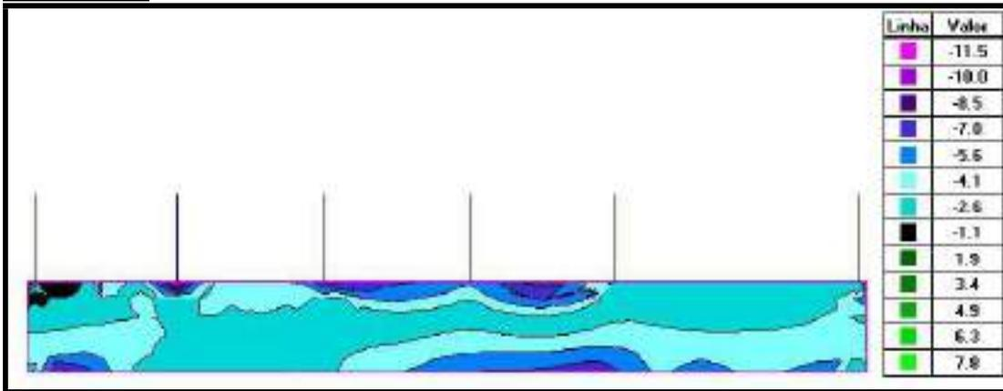
PAR1 - ENVOLTÓRIA DE CARREGAMENTOS MAX - FORÇAS NA DIREÇÃO DE X (tf/m)
