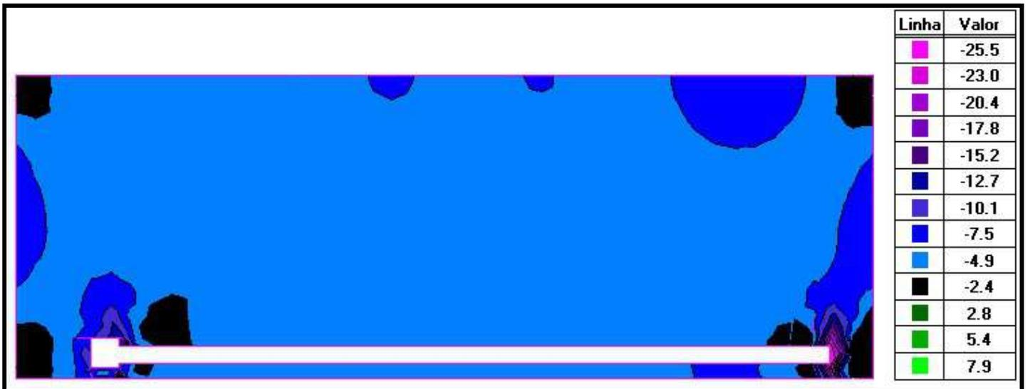
FUNDO – NÍVEL 43.000 – ENVOLTÓRIA DE CARREGAMENTOS MIN - FORÇAS NA DIREÇÃO DE Y (tf/m)
