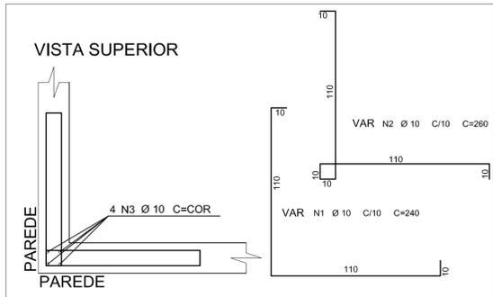
DETALHE DE LIGAÇÃO PAREDE-PAREDE DE CANTO (VERTICAL)
