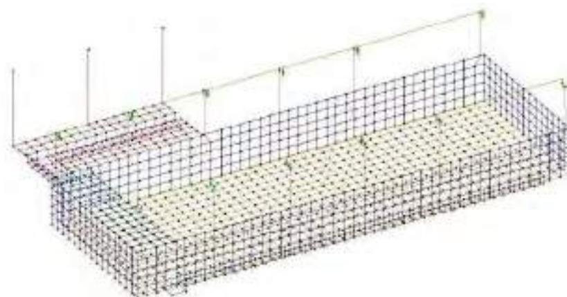
PERSPECTIVA 3D da malha - Estação Elevatória apoiada sobre base elástica
