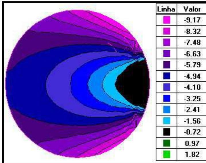
FUNDO – ENVOLTÓRIA DE CARREGAMENTOS MIN - FORÇAS NA DIREÇÃO DE X (tf/m)
