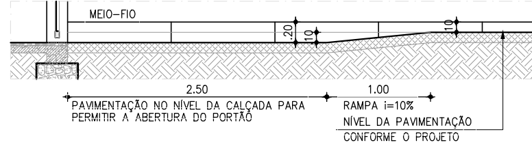
CORTE CC: DETALHE DA RAMPA ESCALA: 1/50
