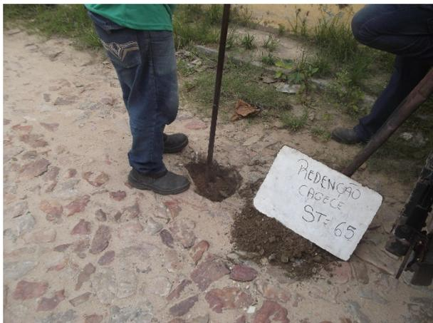
**Foto 07** – Identificação do furo de sondagem a trado ST-65.
