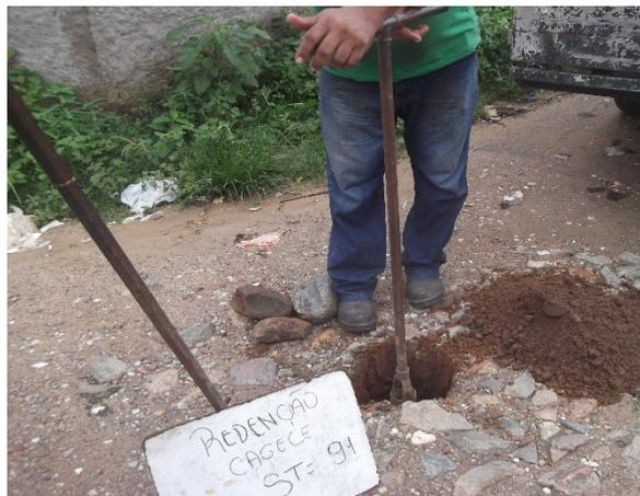
**Foto 08** - Identificação do furo de sondagem a trado ST-91.
