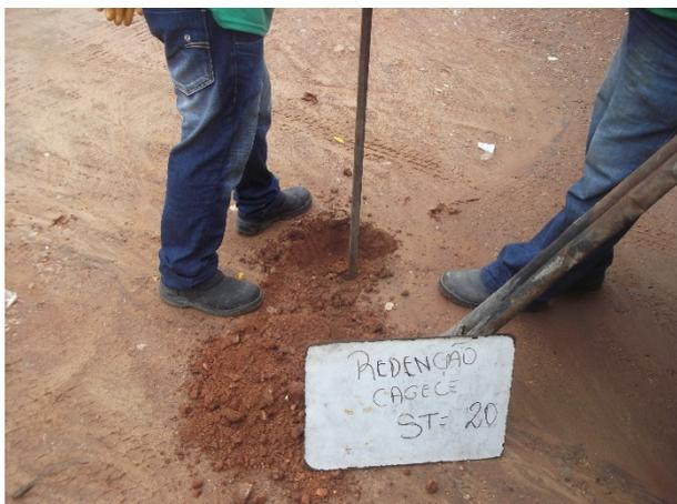
**Foto 05** Identificação do furo de sondagem a trado ST-20.
