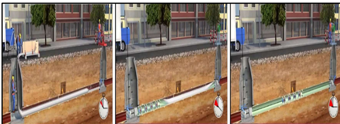
Figura 15: Esquemático da implantação do CIPP por cura UV
