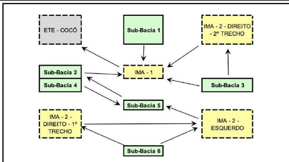
Obs: Toda transferência de efluente se dará de forma gravitária para micro-bacia CE-7, com exceção da micro-bacia 04 e micro-bacia 05 que se darão através das estações elevatórias EECE-9.1 e EECE-9.2, respectivamente.
