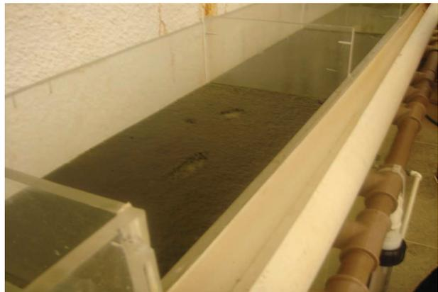
Figura 04 - Unidade Piloto - Lodo Formado
