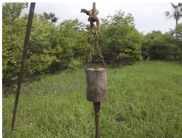
FOTO 02: Detalhe do Peso Batente utilizado nas sondagens
