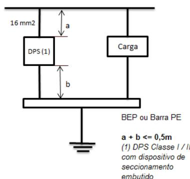
Figura 1 - Condutores de conexão DPS
