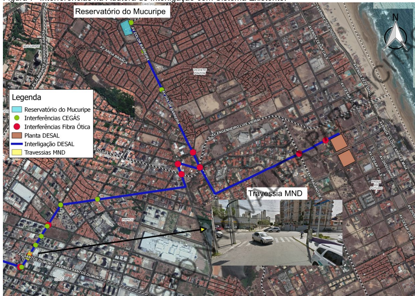
Figura 7- Interferências na Adutora de Interligação com Sistema Existente.
