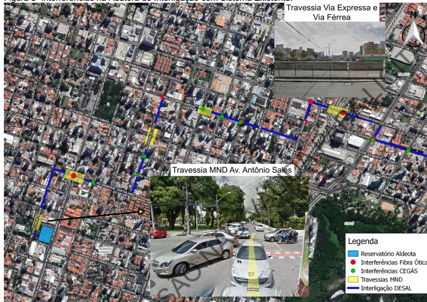
Figura 8- Interferências na Adutora de Interligação com Sistema Existente.
