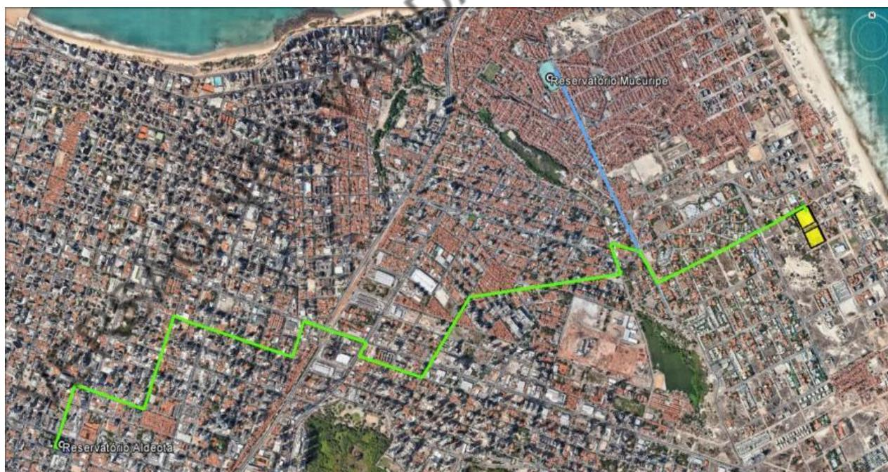
O injetamento das adutoras nos dois pontos escolhidos permitirá o atendimento de toda a vazão produzida na usina de dessalinização, contudo, o sistema foi dimensionado para que, em ocasiões especiais, quando o reservatório do Mucuripe encher, toda a água produzida pela usina possa ser
