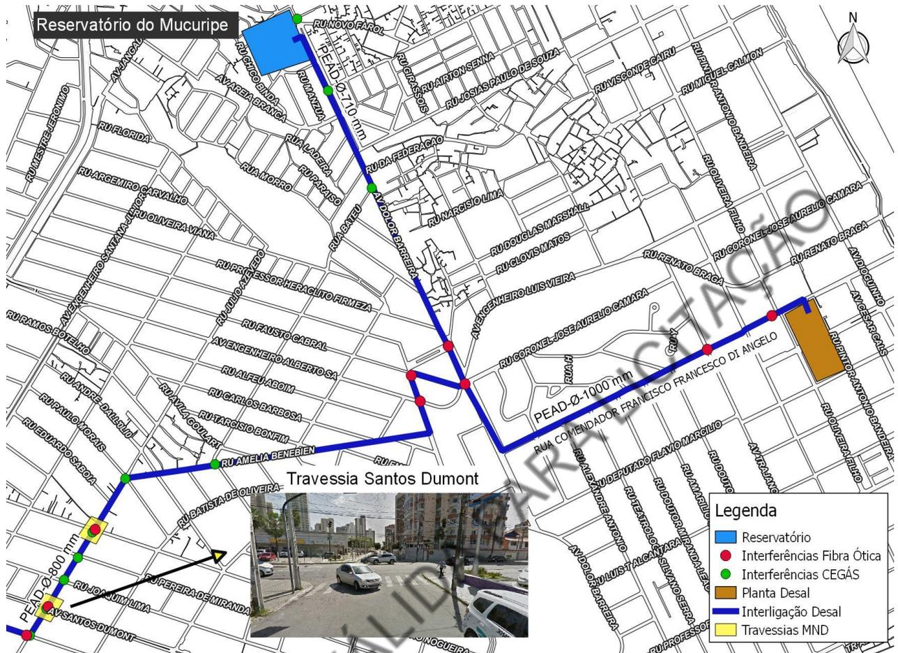
Figura 4.6.2 - Interferências na Adutora de Interligação com Sistema Existente (parte 2)
