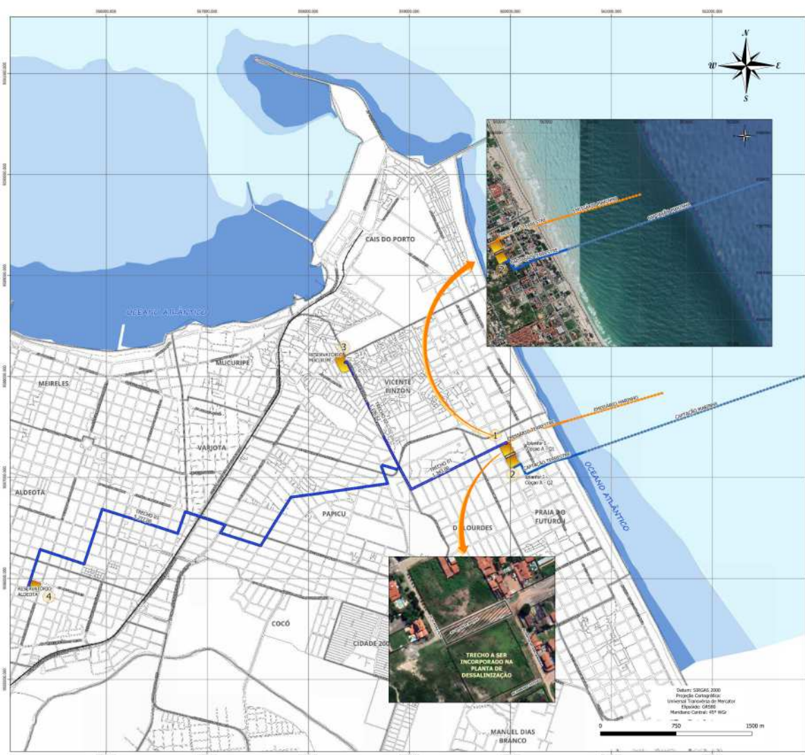
Figura 4. Região avaliada com indicação da locação da planta de dessalinização, do emissário submarino e da linha de captação de água marinha.
