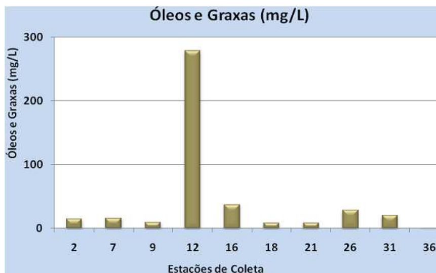
Figura 102 - Distribuição Horizontal Próximo da Superfície de Óleos e Graxas (mg/L) - Região Entorno do Porto do Mucuripe, em dezembro de 2010
