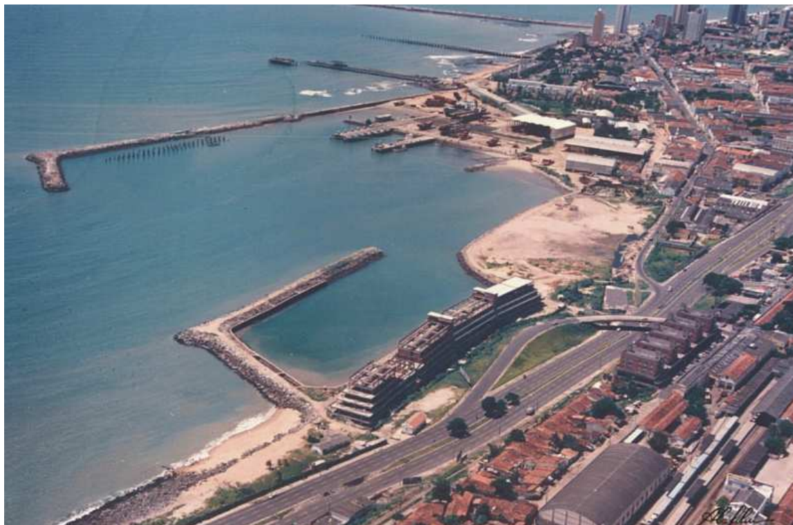
Figura 118 - Série de espigões construídos para diminuir os efeitos erosivos decorrentes da construção do Porto de Mucuripe em Fortaleza.
