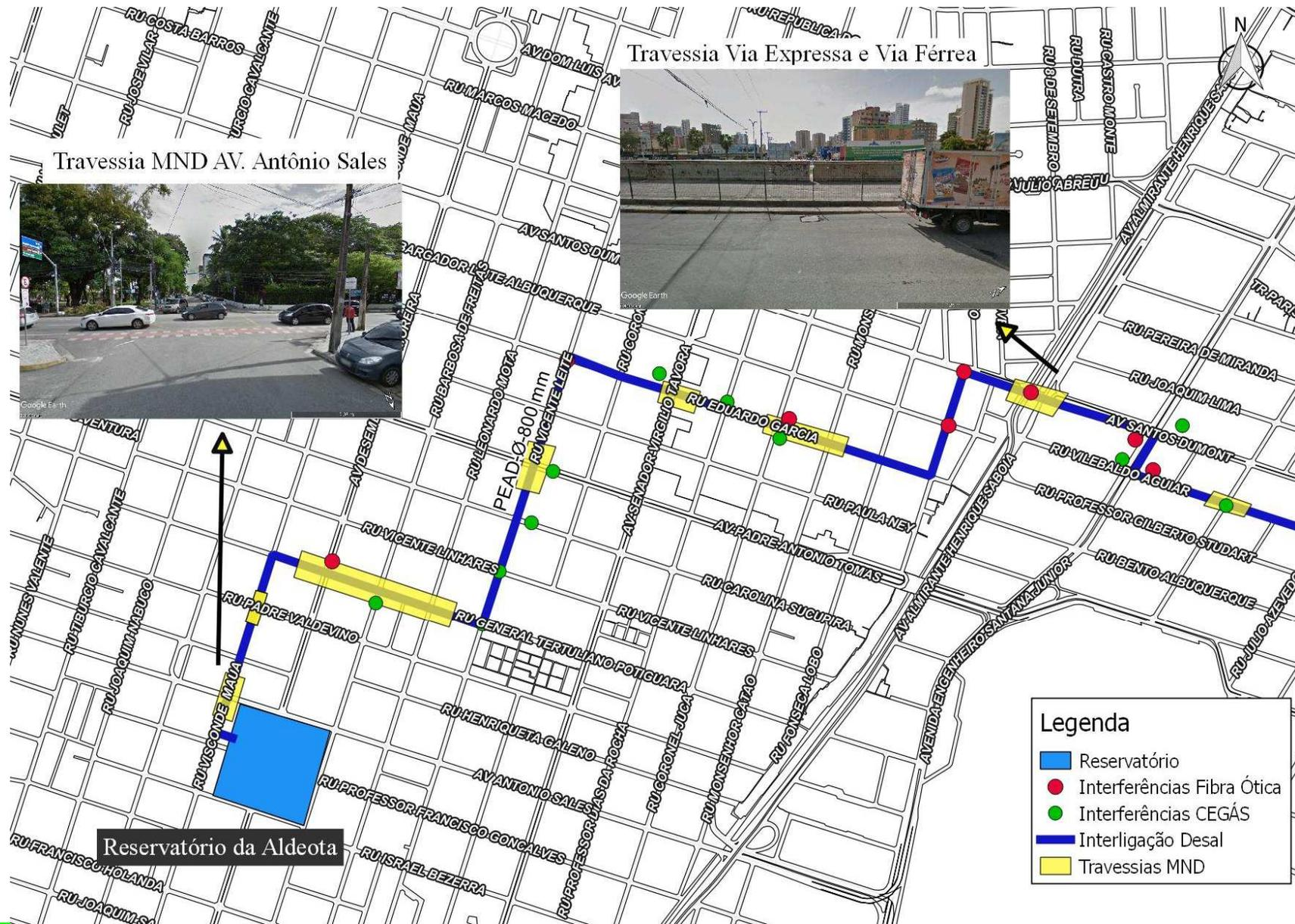
Por se tratar de uma área urbana extremamente adensada e de uso industrial, é inevitável que se observe interferências com diversas redes já existentes em seu caminhamento (água, esgoto, gás, fibra ótica, drenagem e vias férreas).
