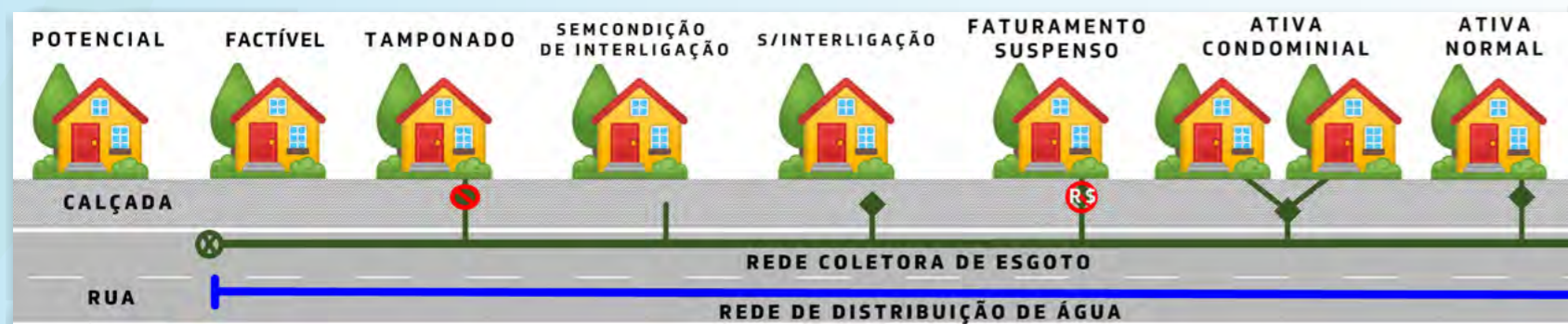
Figura 2: Situações de Ligação de Esgoto
