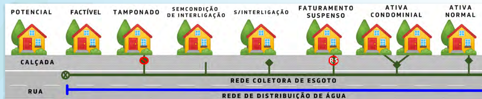
Figura 2: Situações de Ligação de Esgoto
