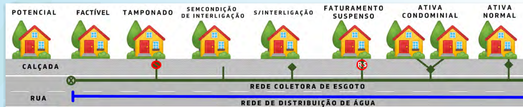
Figura 2: Situações de Ligação de Esgoto
