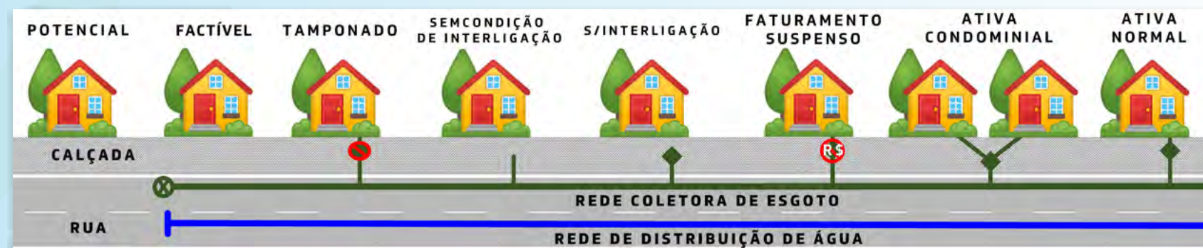
Figura 2: Situações de Ligação de Esgoto
