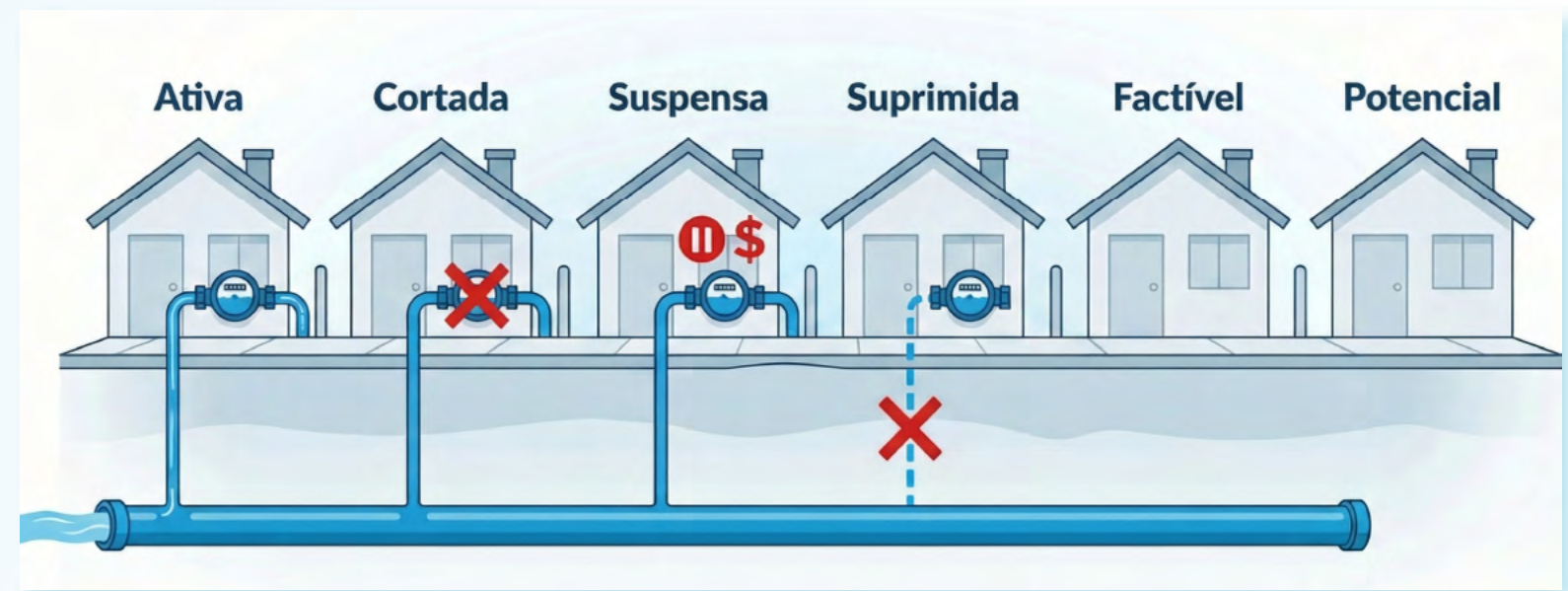
Figura 1: Situações de Ligação de Água
