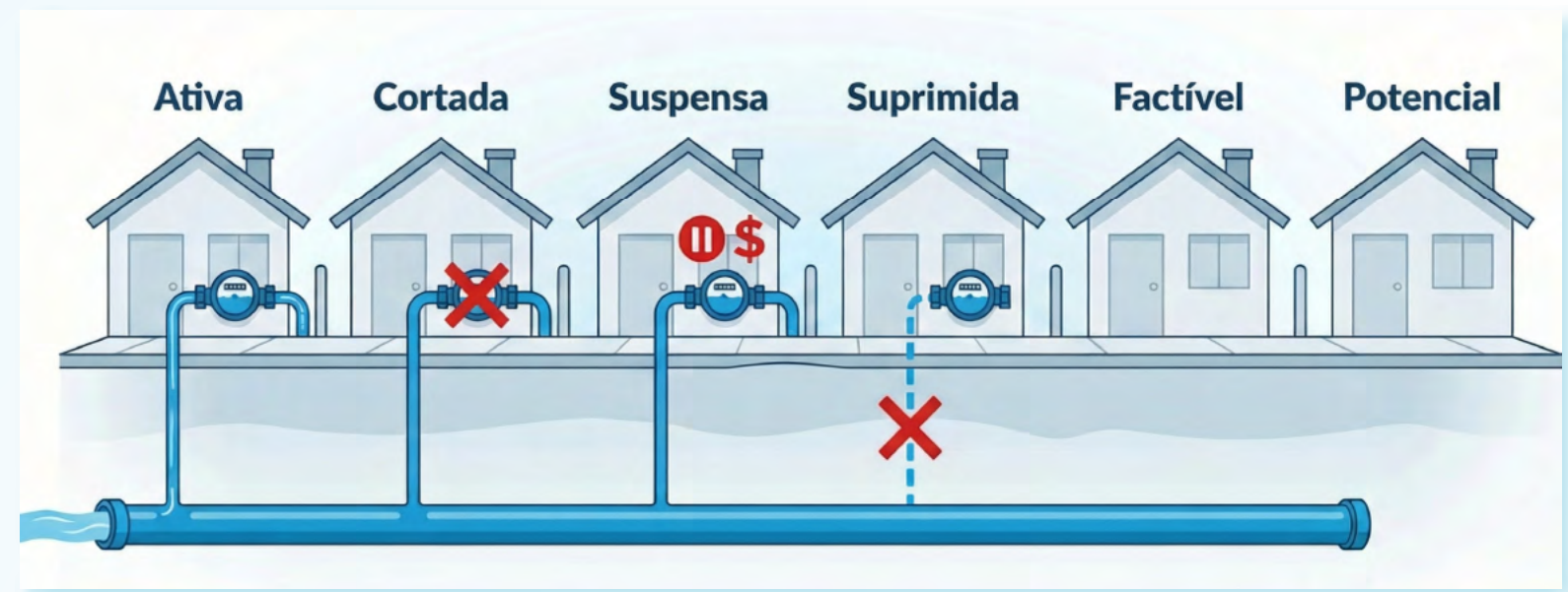
Figura 1: Situações de Ligação de Água
