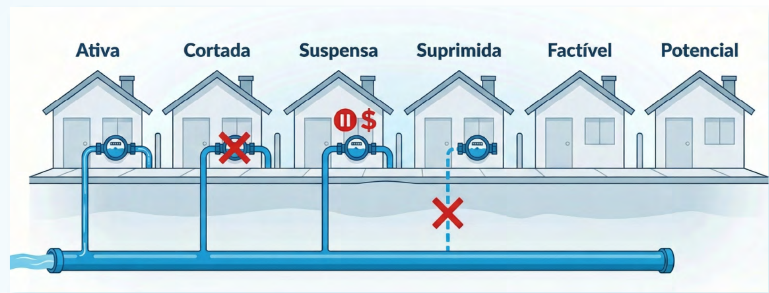
Figura 1: Situações de Ligação de Água
