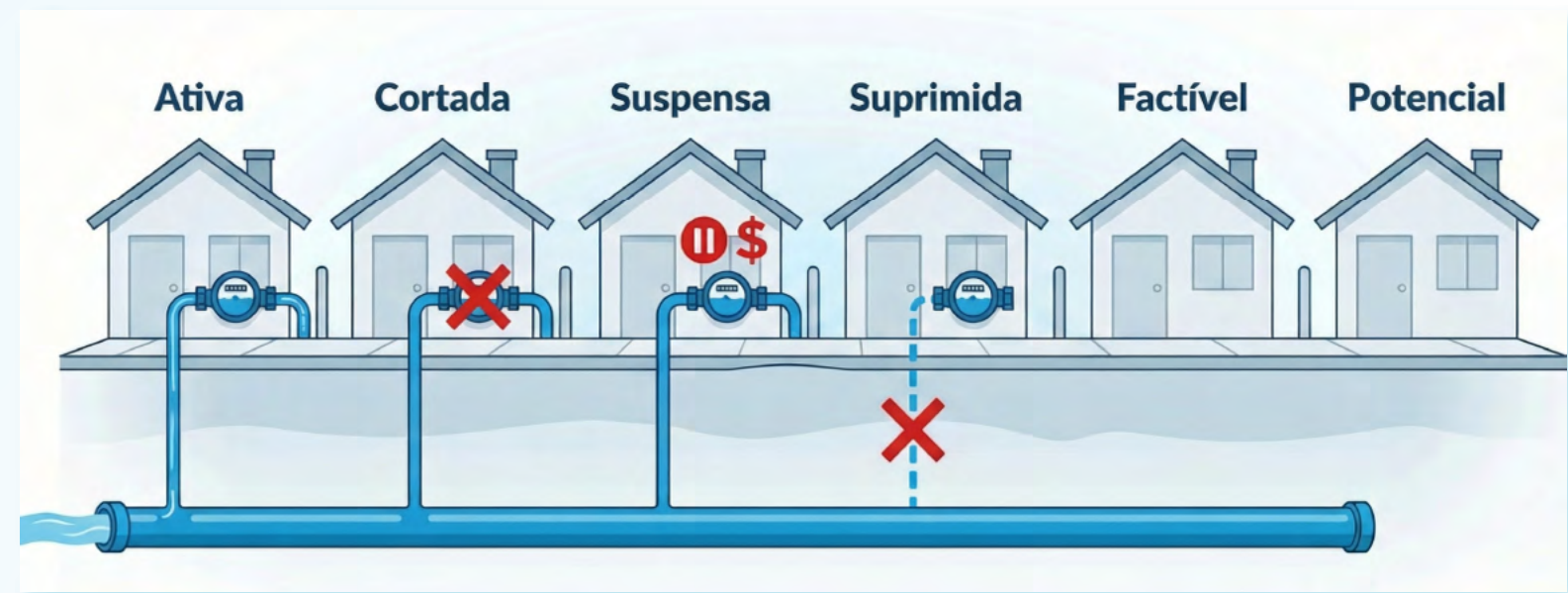
Figura 1: Situações de Ligação de Água
