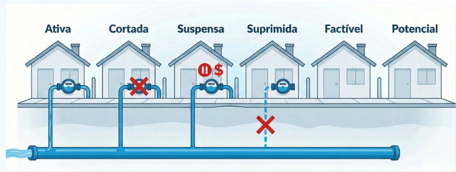
Figura 1: Situações de Ligação de Água
