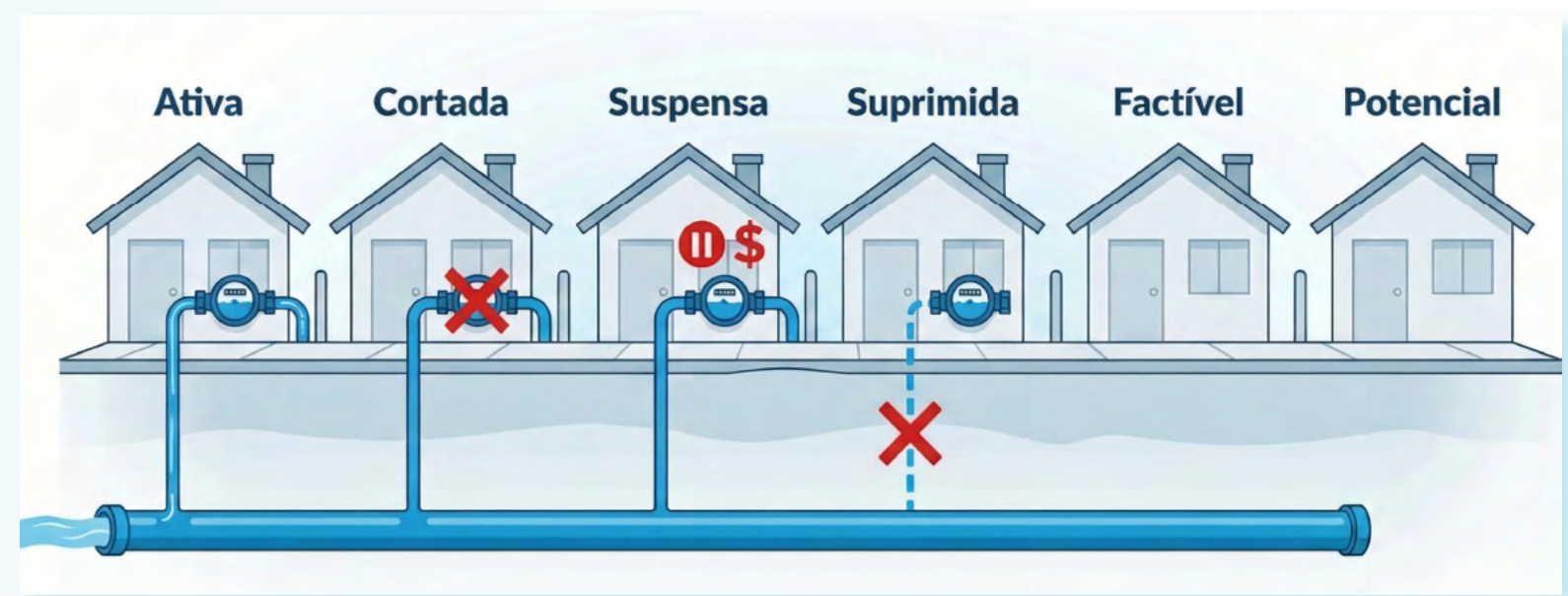
Figura 1: Situações de Ligação de Água
